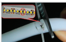
Перемещая ножницы влево или вправо, найдите специальное место разреза на плате. Разрежьте ленту строго по обозначенной линии
