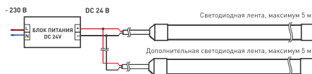
Рисунок 2. Схема подключения лент к источнику питания при температуре окружающей среды более +40 °С
