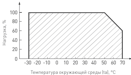
Рис. 2. Максимальная допустимая нагрузка, % от мощности источника
