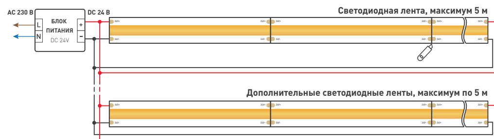
Схема 1. Подключение нескольких светодиодных лент с двух сторон
