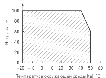
Рис. 4. Максимальная допустимая нагрузка, % от температуры окружающей среды
