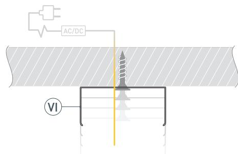
3 / Установите на профиль ① глухие заглушки ③ или заглушки с отверстием ⑤. Перед приклеиванием ленты рекомендуется обезжирить поверхность профиля ①. Установите в профиль ① светодиодную ленту ④ и пропустите кабель питания ленты через изоляционную втулку в профиле ① либо через отверстие в заглушке ⑤.
