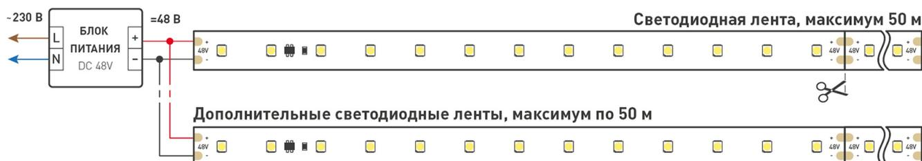
Схема подключения нескольких светодиодных лент с одной стороны.
