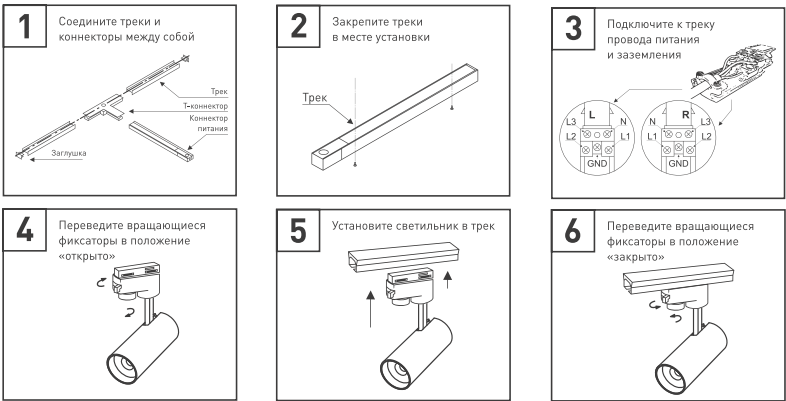
Рис. 2. Установка и подключение светильника
