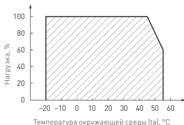
Рис. 3. Максимальная допустимая нагрузка, % от мощности источника
