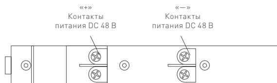
Расположение контактов на шинопроводе и в коннекторе питания MAG-ORIENT-CON-POWER (пластиковая крышка снята)
