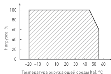
Рис. 3. Максимальная допустимая нагрузка, % от мощности источника
